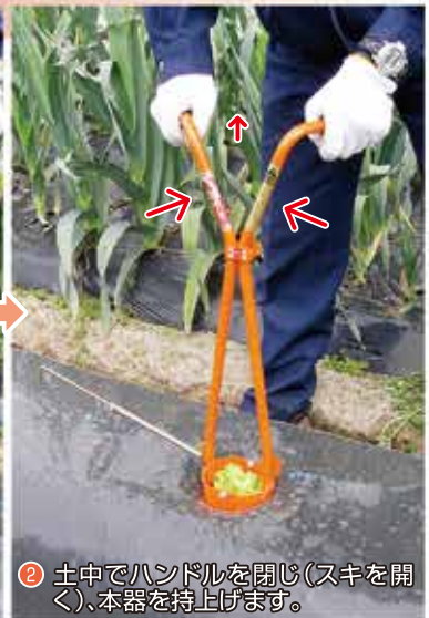
② ステップに足をかけてさらに深く差し込み、土中で少し回転させてから真上に持上げると、土がくり抜けます。
