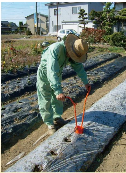
① ハンドルを開き、クラウン内にポット苗を入れます。 ② ハンドルを開いてクラウンを閉じたまま土中にさし込みます。 ③ 土中でハンドルを閉じてクラウンを開き、ポット苗を植え付けます。 ④ ハンドルを閉じてクラウンを開いたまま引き上げて土を覆います。
