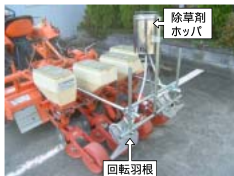
図7. 播種同時除草剤(細粒剤)散布機 注) S社市販機(型式: KT10A-120P2)
