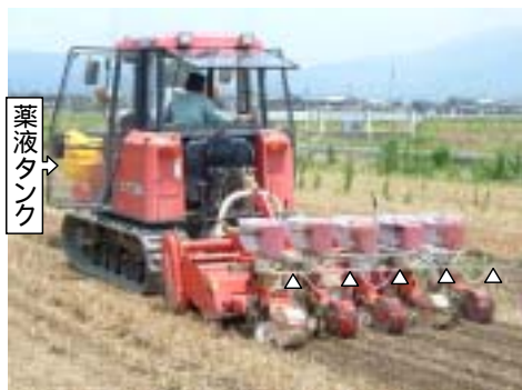
図6. 播種同時除草剤(液剤)散布機 注) 1. S社市販機 2. 図中の \triangle はノズル位置を示す。
