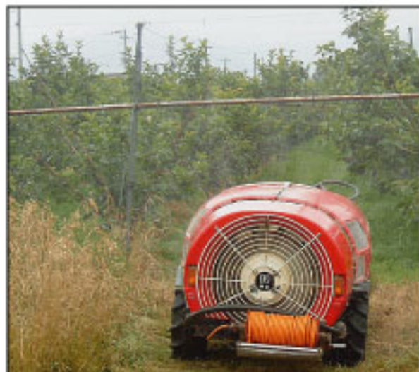
エポックノズル(PC80-100)の散布状態
